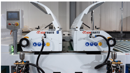
Двух вальцовая система нанесения
