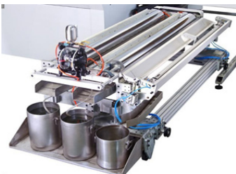
Система очистки конвейерной ленты и рекуперации краски
