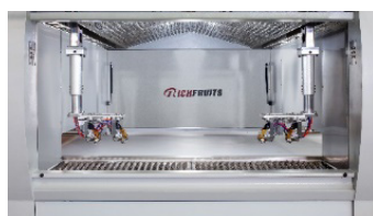
Две каретки с 4-мя распылительными пистолетами на каждой
