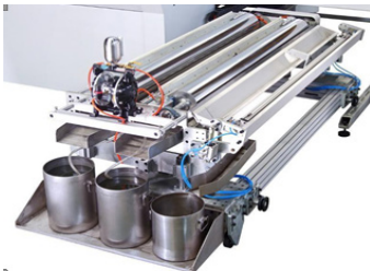
Система очистки конвейерной ленты и рекуперации краски
