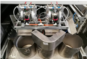
Система очистки конвейерной ленты и рекуперации краски
