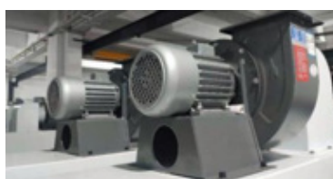
Индивидуальные вентиляторы для отвода тепла из зоны работы УФ ламп. Моторы Siemens
