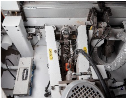
Шлифовальный агрегат с утюжком
