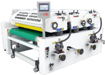
Двухвальный станок с металлическим растирочным валом
