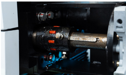
Муфты для плавного вращения валов
