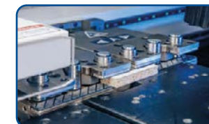
ДВА АВТОМАТИЧЕСКИХ ЗАХВАТА особой конструкции и системой обдува
