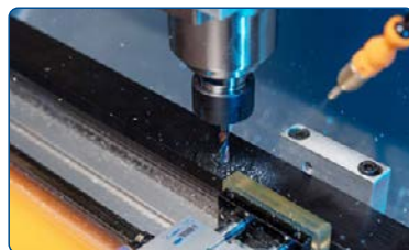
Фрезеровка и сверление алюминиевых профилей
