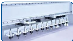
Магазин смены инструмента линейного типа на 12 позиций
