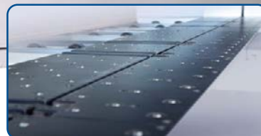
ВОЗДУШНАЯ ПОДУШКА В ЗОНЕ РАСКРОЯ Защищает деликатные материалы от царапин
