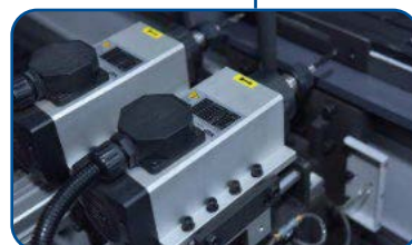
ДВОЙНОЙ ШПИНДЕЛЬ для обработки деталей в торец
