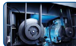
Мощный дисковый тормоз на каждом рабочем агрегате
