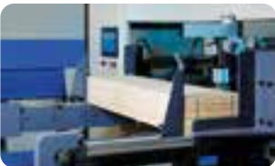
Магазин автоматической подачи заготовок в зону обработки
