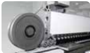
Стальная прижимная балка с ременным прижимом
