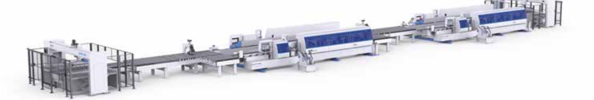
4-х сторонняя линия на базе двухсторонних станков
