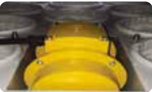
Автоматизированная вибрационная очистка рукавов
