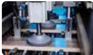
Равномерный прижим боковыми балками и пневмо цилиндрами
