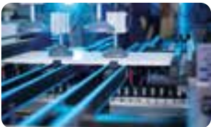
Равномерный прижим боковыми балками и пневмо цилиндрами
