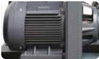
Двигатель IE3 класс защиты IP 23
