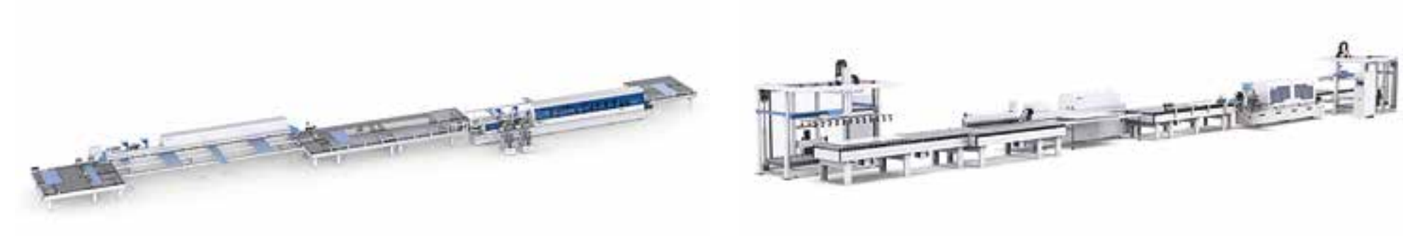
2-х сторонняя линия типа «ТАНДЕМ» на базе односторонних станков
