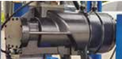
ЧАСТОТНЫЙ ПРИВОД, МОТОР НА ПОСТОЯННЫХ МАГНИТАХ, МАСЛЯНОЕ ОХЛАЖДЕНИЕ
