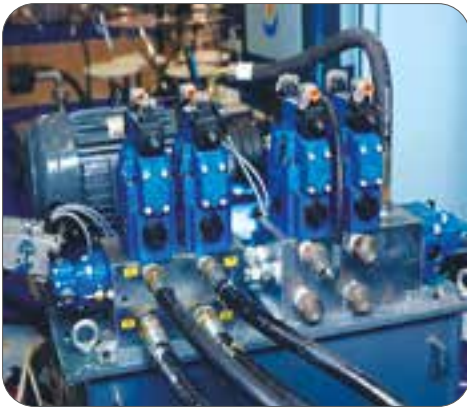
Надежная гидравлическая станция. Установка давления с помощью электроклапана прямого действия, без необходимости ручной регулировки клапана
