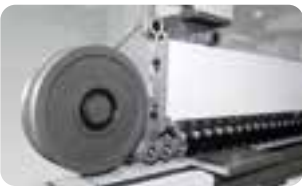
Стальная прижимная балка с ременным прижимом
