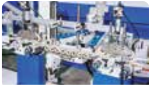
Шлифовальный агрегат «S» с пневматическим утюжком
