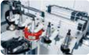
Магазин на 5 позиций в т.ч. угловая передача
