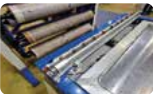
Система очистки и обрезки облицовочного материала
