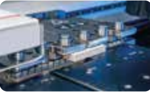
Два автоматических захвата особой конструкции и системой обдува (патент KDT)
