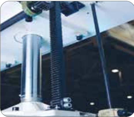
Надежный механизм контроля параллельности подъема плиты на основе зубчатых реек и вала с шестернями. Контактный выключатель подъема
