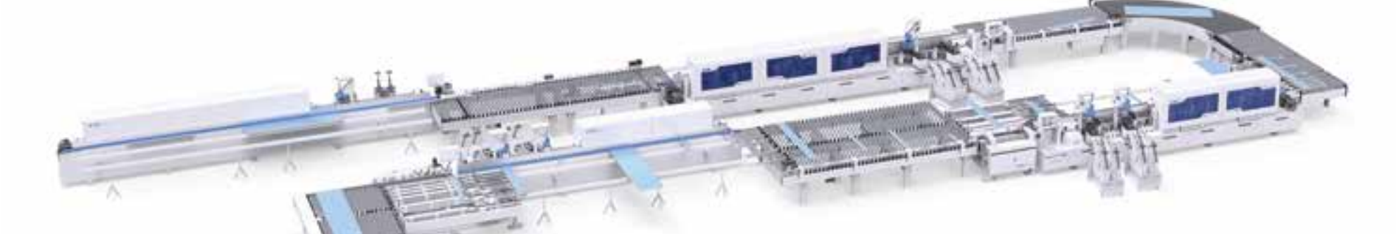
4-х сторонняя линия для узких заготовок на базе односторонних станков
