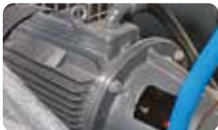
Двигатель IE3 класс защиты IP 54
