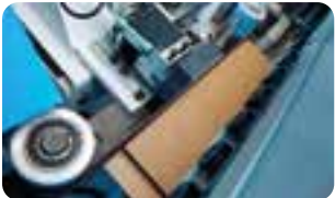
Шлифовальный агрегат «S» с пневматическим утюжком
