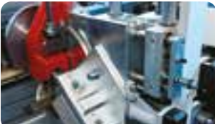
Фрезерный узел «J» с копирувальным устройством
