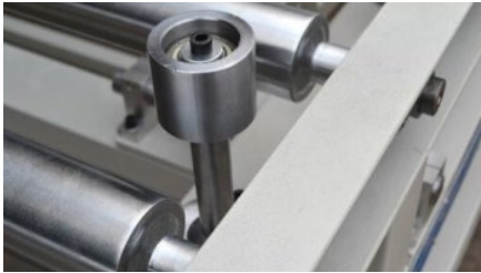
Роликовый транспортер оснащен системой автоцентрирования заготовок
