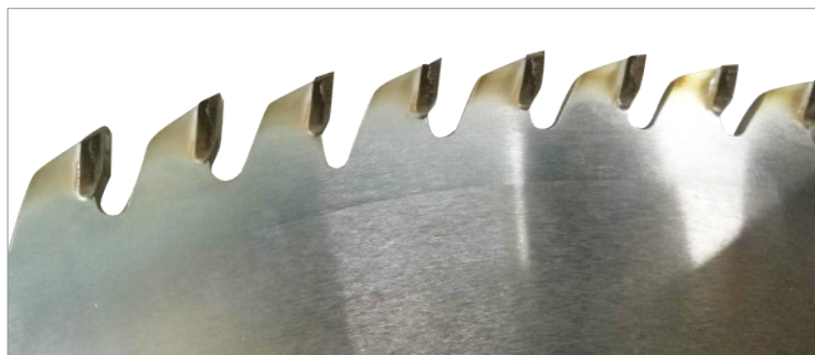
Рис 5. Отложения смолы на твердосплавных напайках и корпусе пилы
