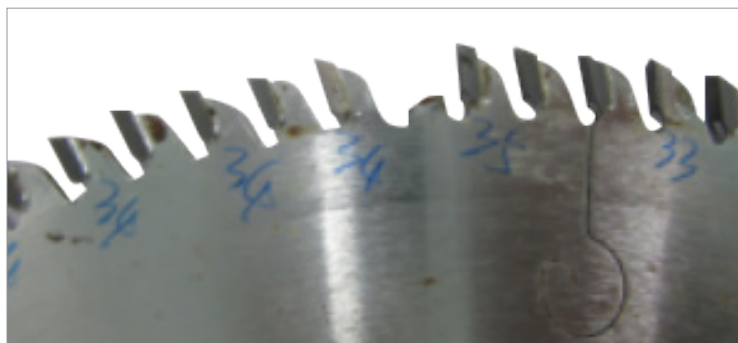
Рис 1. Ударное воздействие на пильный диск
