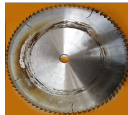
Рис 4. Следы биения пильного диска
