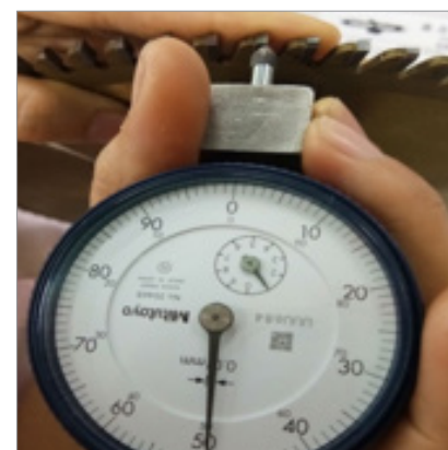
Рис 3. Твердосплавная напайка в деформированном состоянии
