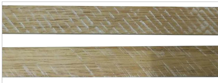
Рис 2. Следы инструмента на обрабатываемой поверхности
