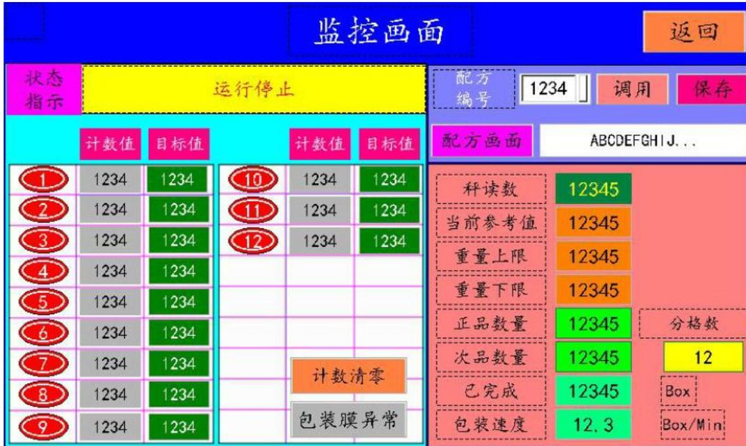
4.3.1 «状态显示» («Отображение состояния»): основная функция этого экрана заключается в контроле состояния линии фасовки в реальном времени в штатном режиме работы.
