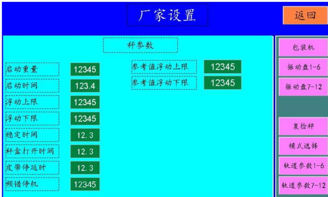
**4.5.3.1 «启动重量» («Настройка начального веса»):** после задания значения данного параметра весы начнут работать только тогда, когда вес продукции превысит этот начальный вес.
