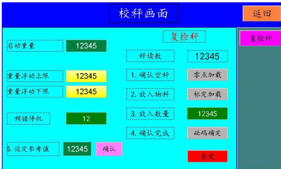
**4.10.1 «启动重量» («Настройка начального веса»):** после задания значения данного параметра весы начнут работать только тогда, когда вес продукции превысит этот начальный вес.
